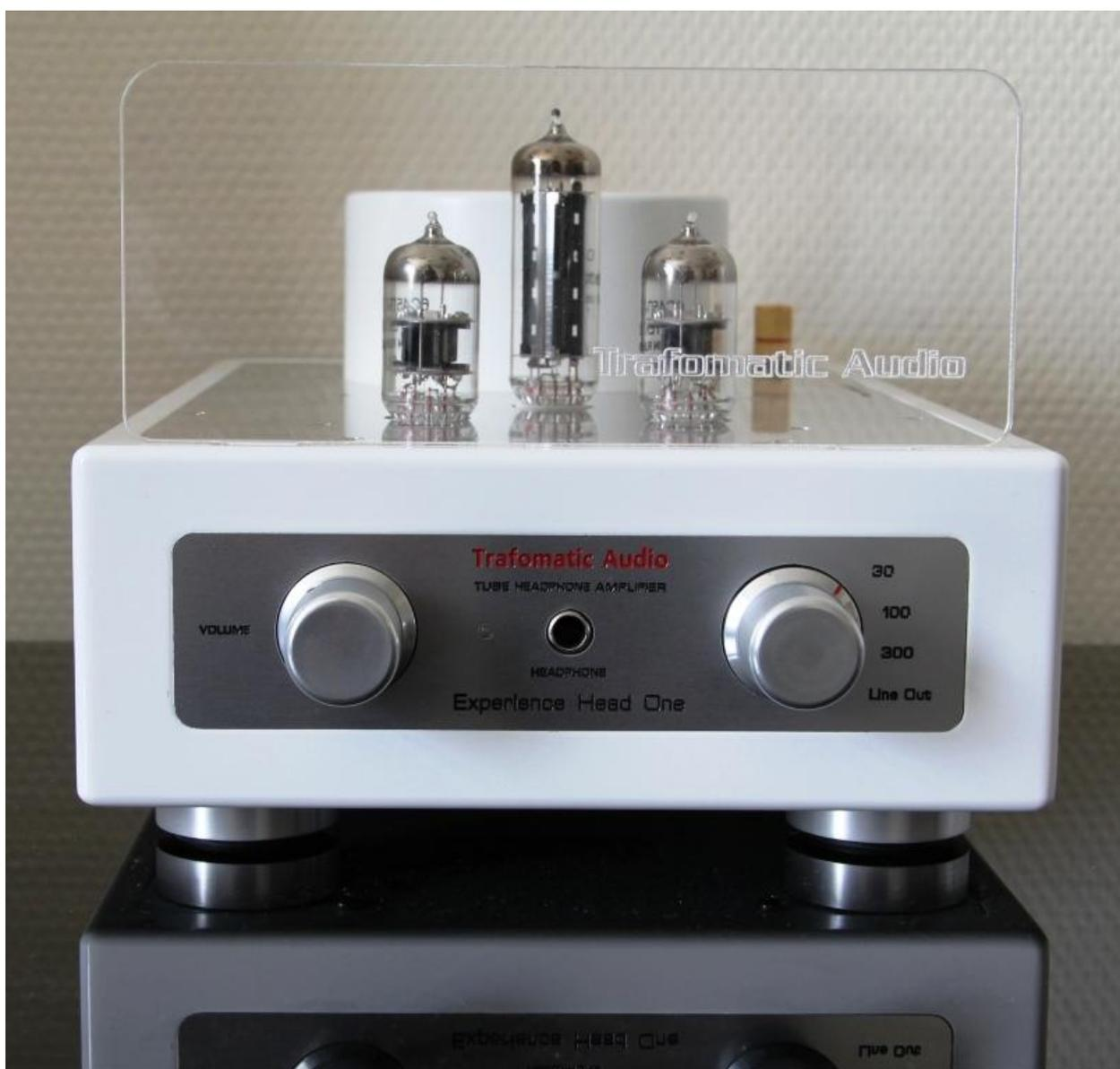
**Верхняя панель из отполированного алюминия. На передней панели ручка управления громкостью, переключатель сопротивления нагрузки и выхода LineOut, гнездо для наушников.**
